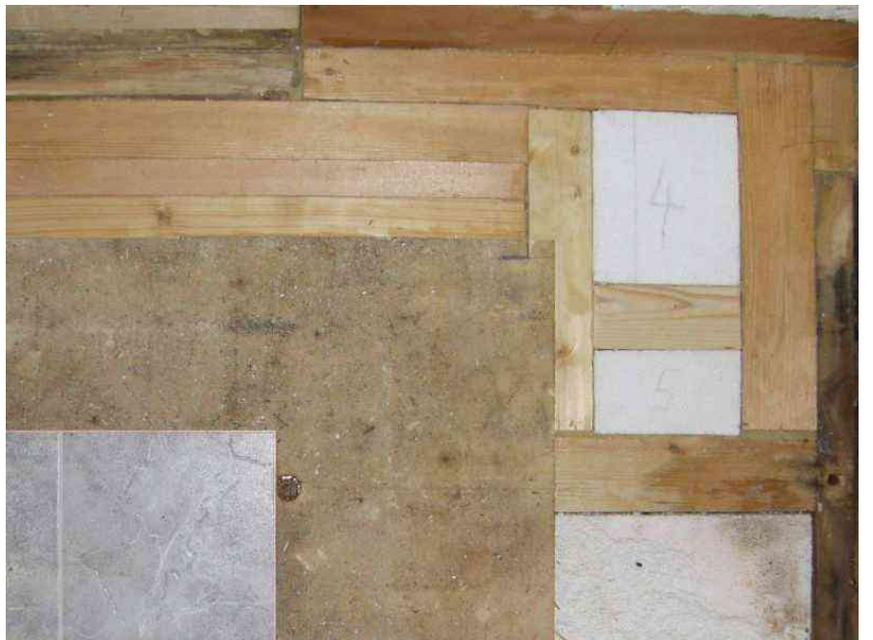
An der untersten Heckplatte hab ich dann noch kurze senkrechte Hölzer eingebaut. Hier ist die Sitzgruppe mit schrägen Plastikwinkeln angeschraubt. Im Original nur in die Sperrholzplatte, und nicht sonderlich fest !
